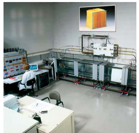
Luftfilterprüfstand nach DIN EN 779
